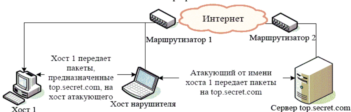
Рисунок 9. Схема реализации угрозы "Навязывание ложного маршрута" (межсегментное) с целью перехвата трафика
